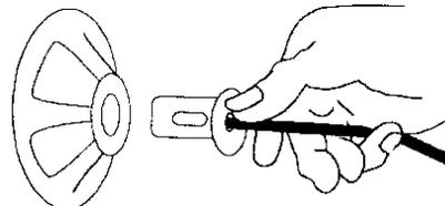
Saisir le dispositif de retenue de l'ampoule situé à l'arrière de la niche de l'ampoule. Le faire tourner dans le sens inverse aux aiguilles d'une montre pour le dégager de sa niche. Retirer l'ampoule de son réceptacle. La remplacer et la remettre dans sa niche.
